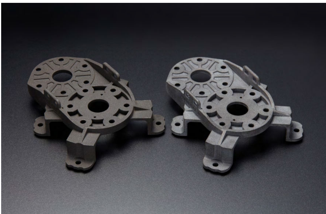
Notre pièce d'essai, avant et après le polissage par vibration. La pièce sablée est gris clair et d'aspect mat.
