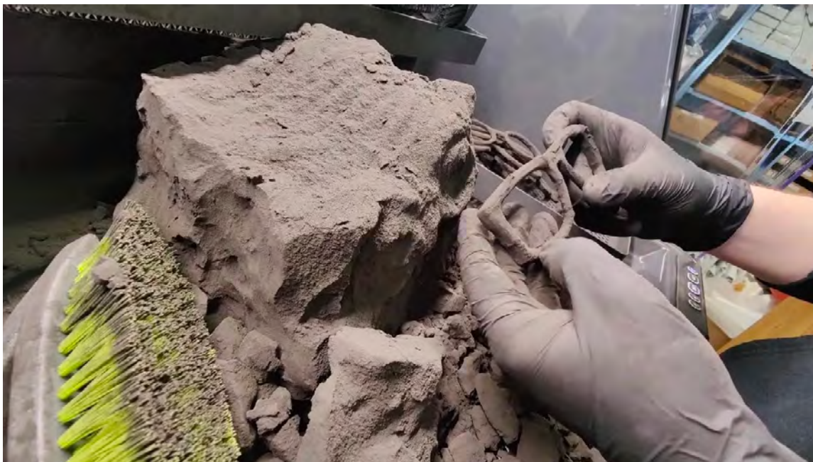
Montures imprimées en 3D avec Nylon 11 Powder et retirées de la chambre de fabrication Fuse 1+ 30W.
