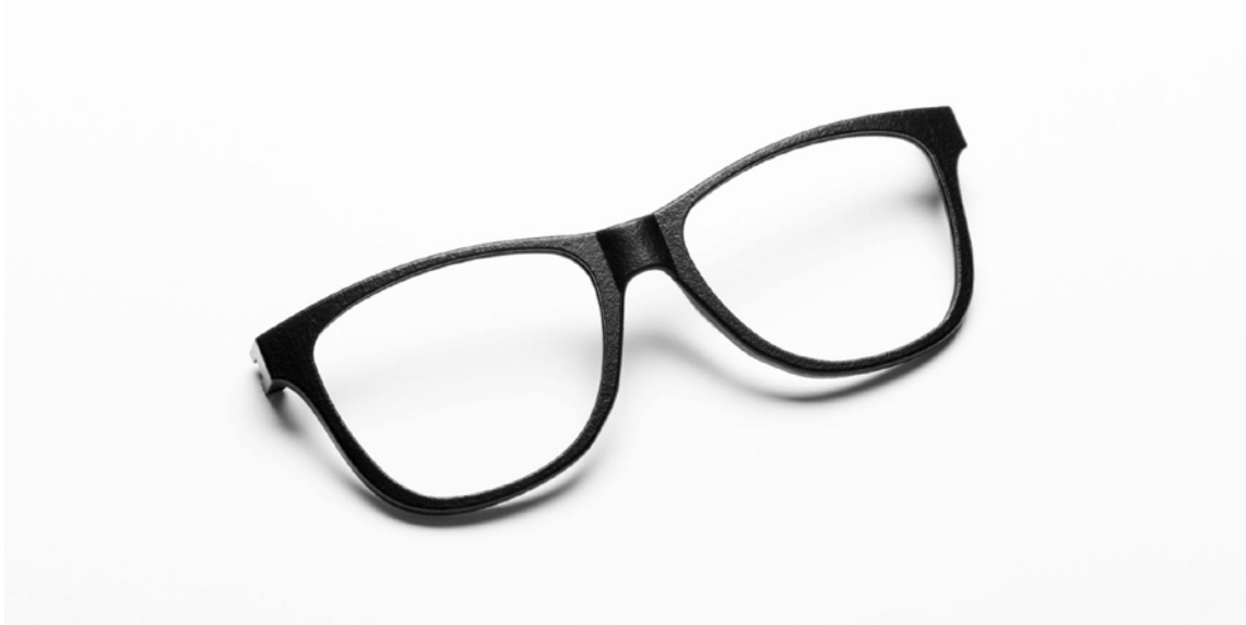
Montures en Nylon 11 Powder après lissage à la vapeur.
