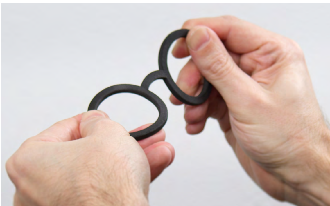
Des montures en Nylon 11 Powder en train d'être tordues.
