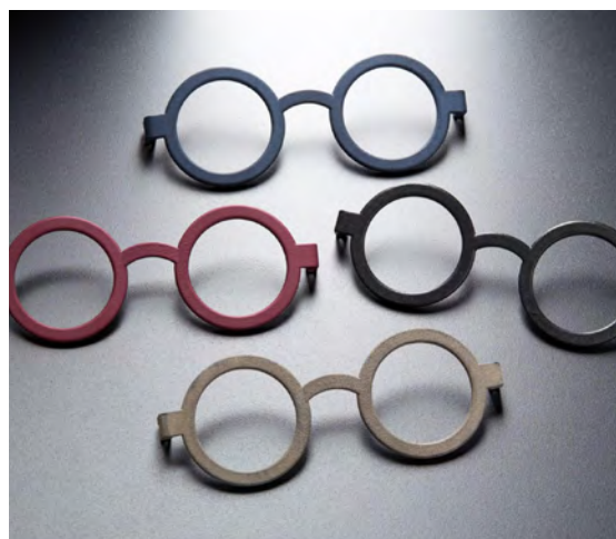
Montures imprimées en PA11 ; (en bas) polie par vibration ; (au centre à gauche) : revêtue de Cerakote ; (Centre droit) lissée à la vapeur ; (Haut) revêtue de Cerakote.
