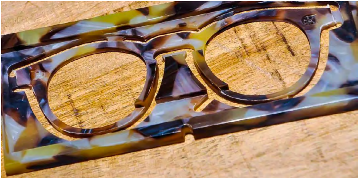
Une monture traditionnelle en acétate créée par un procédé de découpe. Source: Visio Optical.
