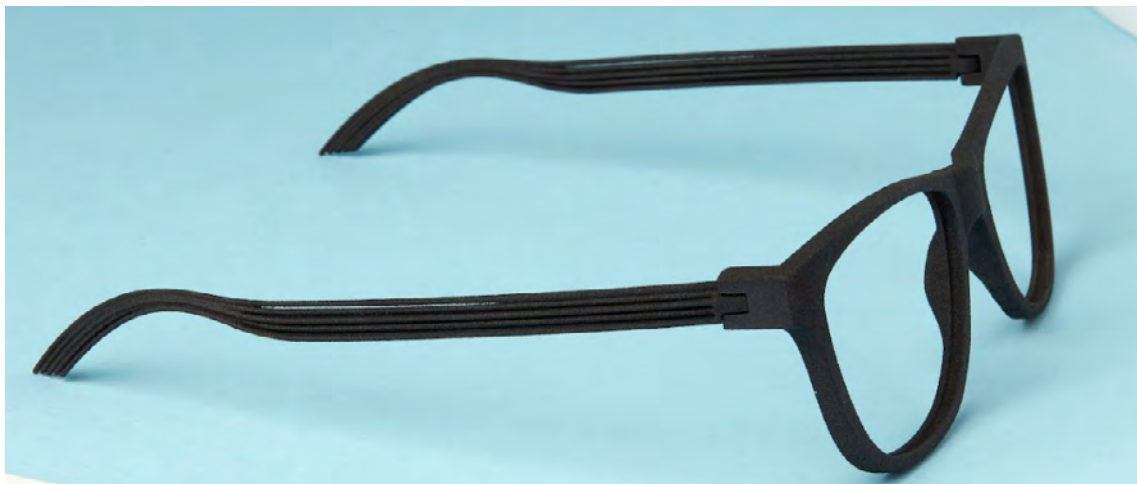
Lunettes assemblées à l'aide d'un filet imprimé et d'une vis en métal.
