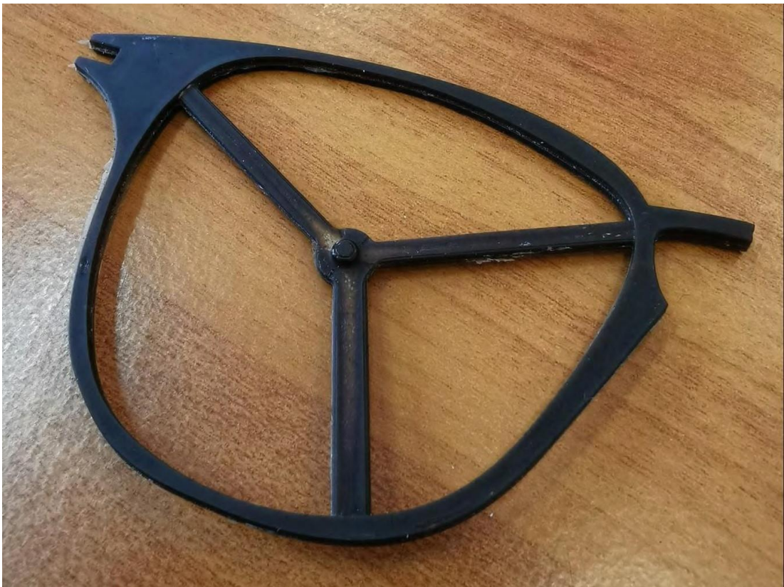
Une monture de lunettes fabriquée avec des moules imprimés en 3D.
